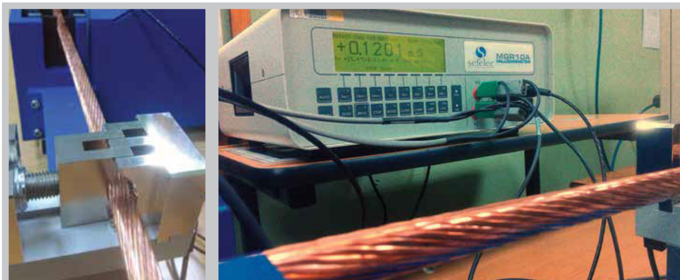
Рисунок 1 Фиксация кабельной жилы (слева) и микроомметр MGR10 (справа)
