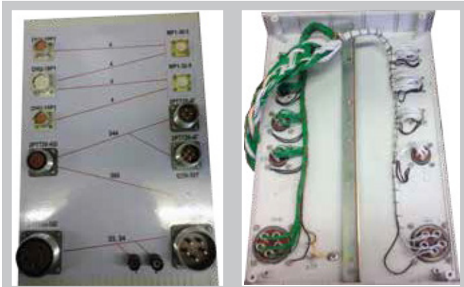
Рисунок 3 Специализированная оснастка с параллельным подключением некоторых разъемов
