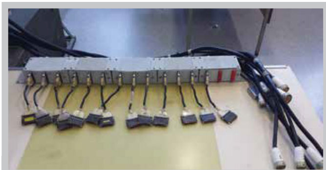
Рисунок 4 Специализированная оснастка с 4-проводным подключением
