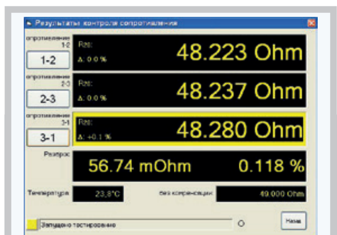
Рисунок 7 Программное обеспечение тестера Schleich MTC2. Ручной режим тестирования: замер сопротивления по всем фазам
