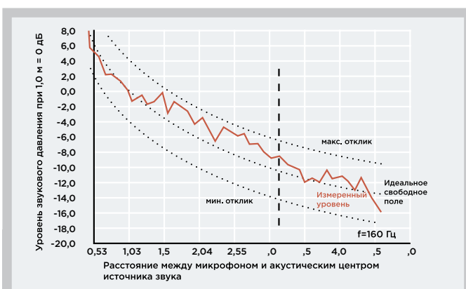
Рисунок 6 Эффективность IAC PlanarCHOIC на частоте 160 Гц и отклонение от закона обратной квадратичной зависимости, кривая 1
