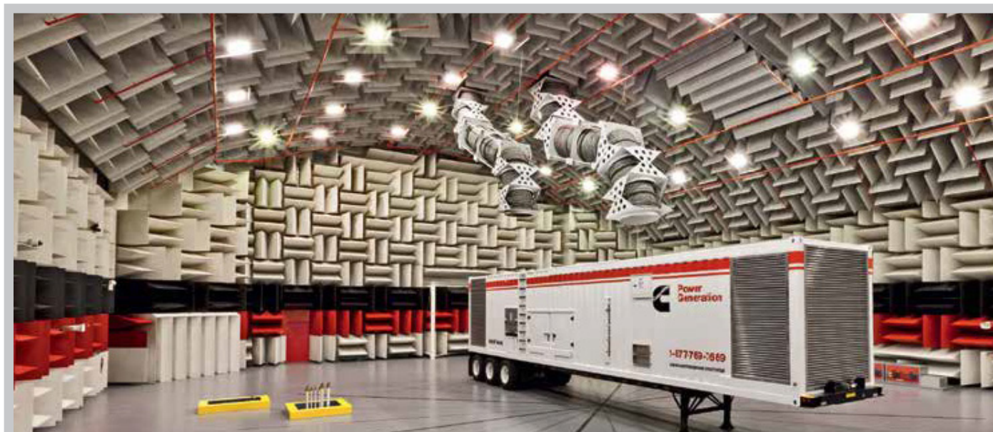
Рисунок 8 Пример реализации безэховой акустической камеры на основе клиновидных поглотителей IAC Metadyne
