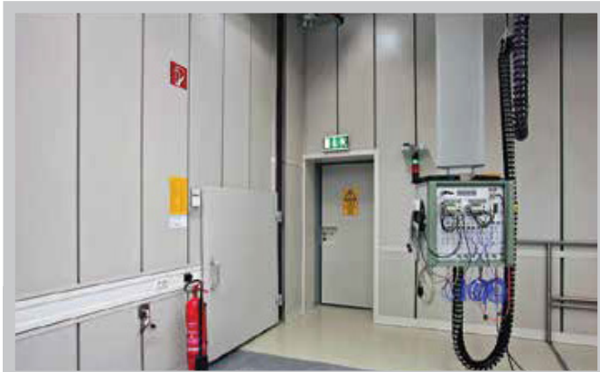
Рисунок 5 Пример реализованной акустической камеры IAC Acoustics с материалом PlanarCHOIC
