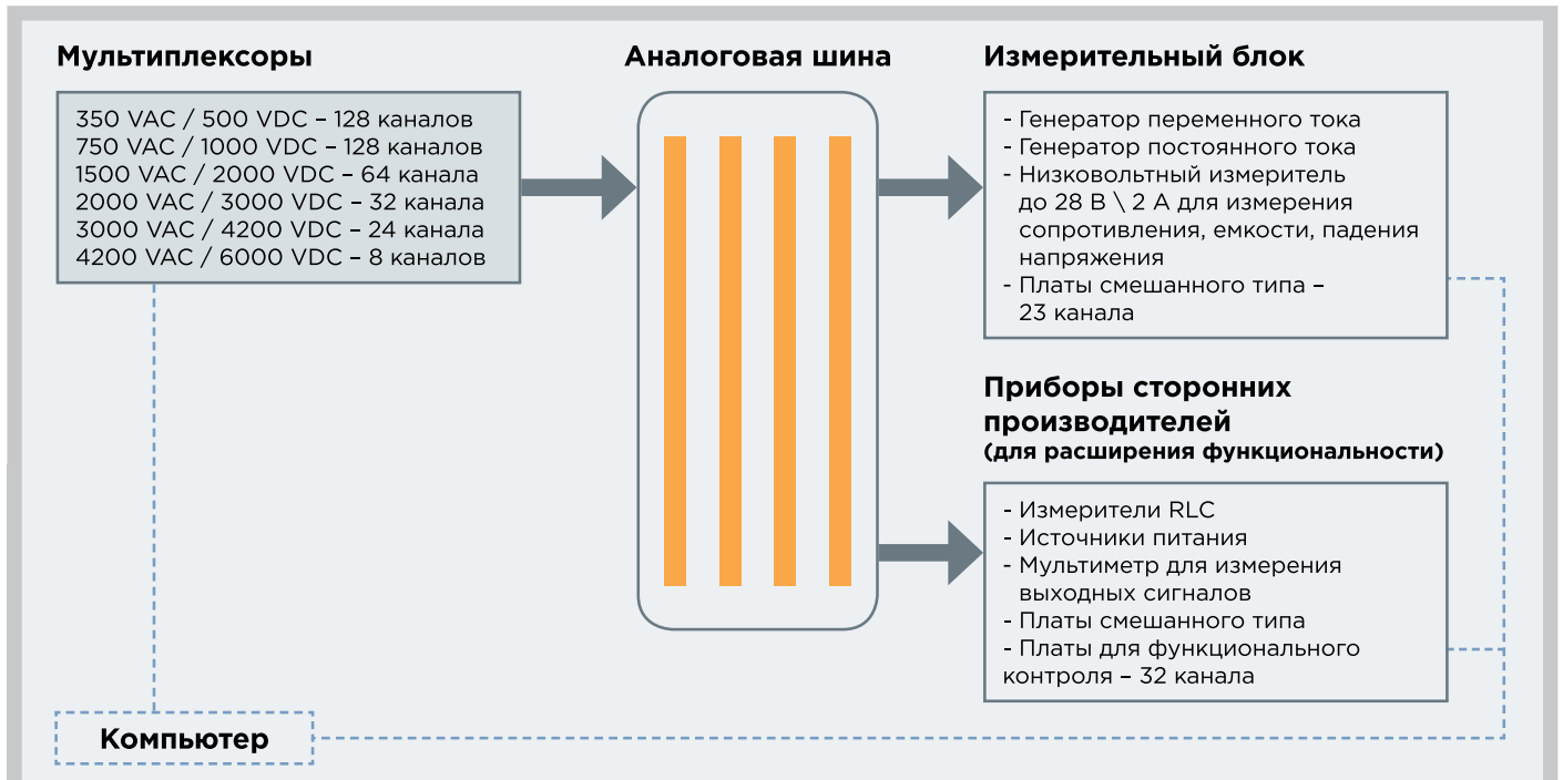
Рисунок 2 Классическая архитектура тестовых систем контроля проводного монтажа.
