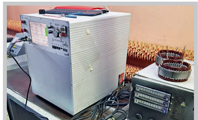
Рисунок 5 Тестер МТС2-6кВ с опцией тестирования прочности изоляции
