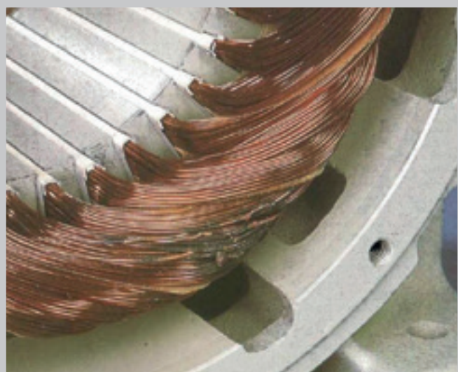
Рисунок 2 Короткое замыкание между витками
