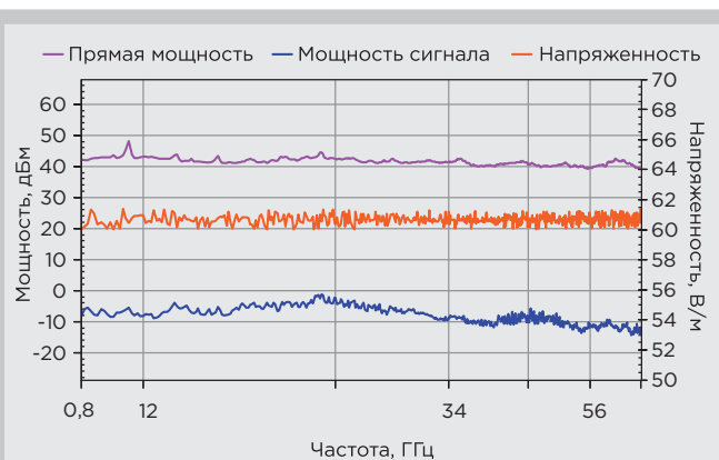
Рисунок 4 Уровень напряженности, создаваемый генератором поля RFS2006BR при вертикальной поляризации
