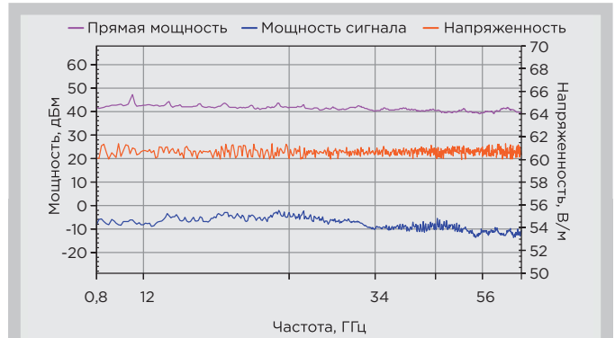
Рисунок 3 Уровень напряженности, создаваемый генератором поля RFS2006BR при горизонтальной поляризации
