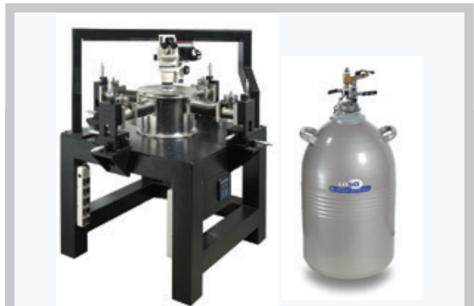
Рисунок 5 Криогенная зондовая станция CG-196 позволяет проводить измерения в диапазоне от -196 до +1000 °С при давлении 0,1 Па
