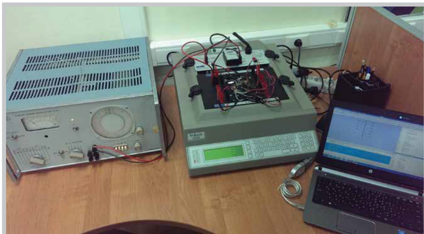
Рисунок 5 Пример рабочего места оператора. Тестер Voltech AT3600, генератор сигналов ГЗ-56/1, ноутбук с ПО
